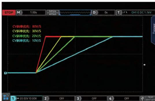
可调节斜率，提高系统稳定性，主要有CC/CV高速优先，CC/CV斜率优先四种可调模式
