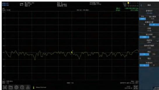
JHS5000A系列显示平均噪声电平低至-163dBm,出色的灵敏度可以有效对微弱信号进行测试
