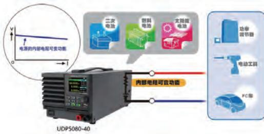
内阻可调，轻松模拟二次电池、太阳能电池、燃料电池等内部电阻
